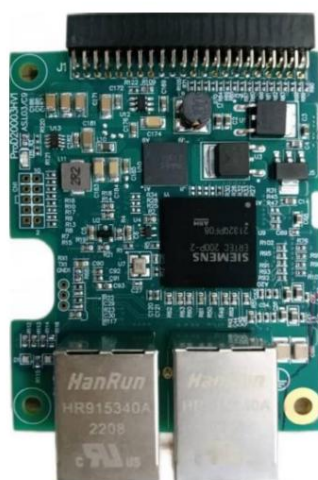
Bo mạch giao tiếp PN, mã hiệu bo mạch: AS.L03/C9
